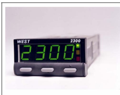
WEST 2300 控制器/显示仪, 具有体积小功能全的特点, 具有 10 mm 高 LED 数码显示, 2A 继电器输出和 3 线制 PT100 或热电偶输入。做控制器时具有 WEST 公司先进的 PID 自整定算法。
